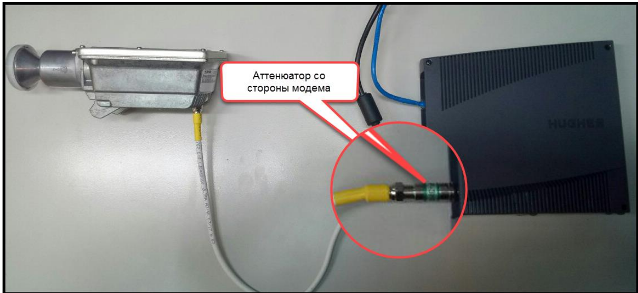
Рисунок – 2 Установка аттенюатора со стороны модема
